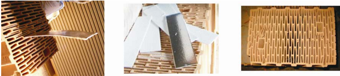
Abbildung 4-9: Hochlochziegel, Vorbereitung für die Verwendung ohne Aluminiumstreifen
